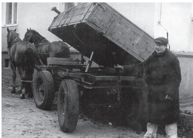
Nowoczesny wóz konny z hydraulicznym podnośnikiem
