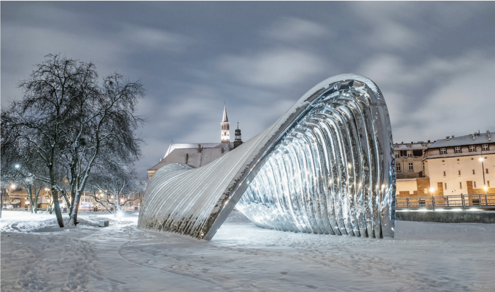
„Nawa” na Wyspie Daliowej we Wrocławiu zbudowana jest z ok. 30 prześel, wykonanych w technologii FiDU. Umożliwia ona spawanie cienkiej blachy i następnie nadmuchiwanie sprężynym powietrzem. Powstają przedmioty i formy stwarzające wrażenie niezwykle lekkich, które są bardzo wytrzymałe i stabilne. Tak skonstruowane rzeźby są niepowtarzalne.
