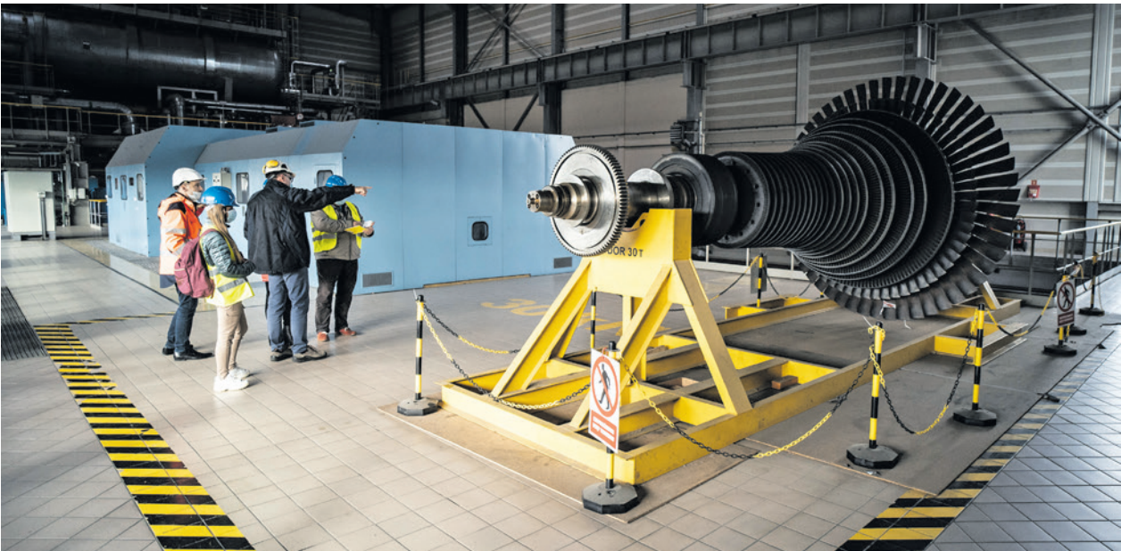
Ten wirnik wymontowany z turbiny waży 26 ton. Jest tak idealnie wyważony, że może go obrócić jeden człowiek. W tle turbosespół parowy „Józef”, nazwany tak na cześć Józefa Pupki, osoby zasłużonej dla EC.
