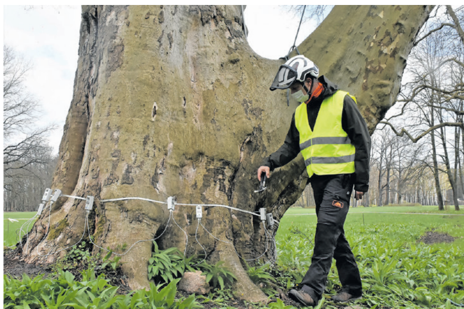
Maciej Motas lekko uderza młotkiem w gwoździe wbite w drzewo, na których zamontowane są czujniki. To badanie rezonansem akustycznym. FOT. TOMASZ CZYŻNIEWSKI
