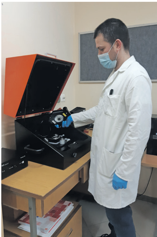
Dr Maciej Marć przygotowuje do pomiarów mikroskop sił atomowych FOT. KATARZYNA DOSZCZAK
