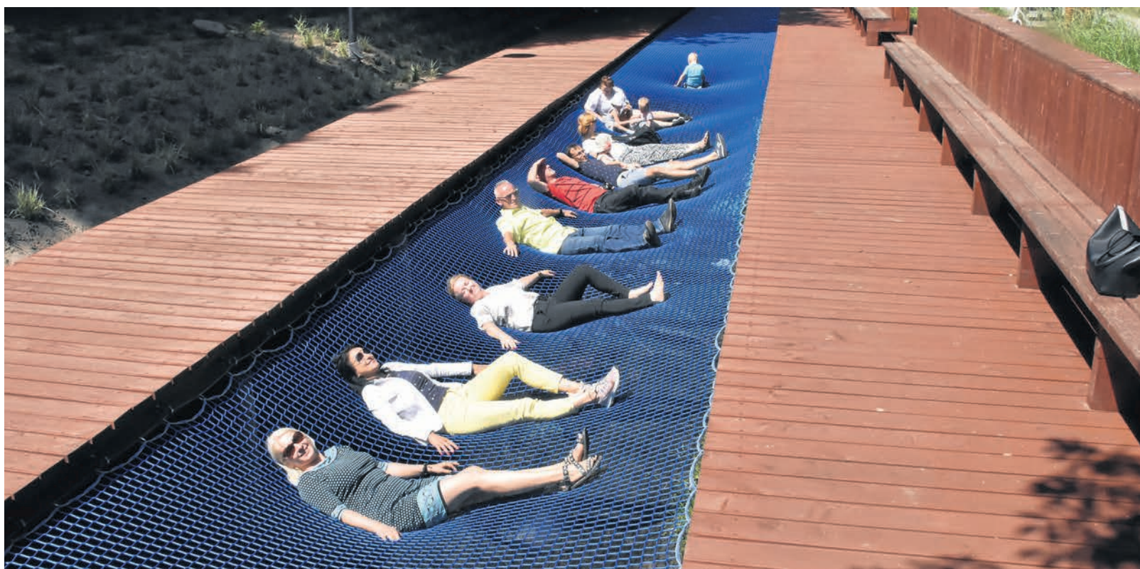
Próba wytrzymałości siatki – bez problemów leży na niej około 10 osób
