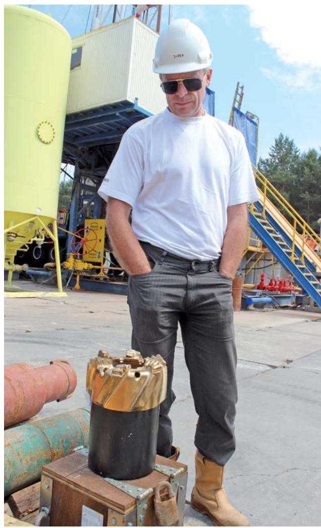
Krzysztof Bawół (od sześciu lat na wiertniach) i Jerzy Macek (od 27 lat na wiertniach) pokazują specjalny świder rdzeniowy. To przy jego pomocy zostanie pobrana próbka z warstwy zawierającej miedź.
