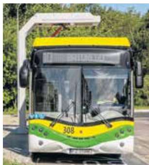
Autobus elektryczny ursus ma 12 metrów długości, waży 18 ton i jednorazowo może zabrać na pokład 82 pasażerów, w tym 31 pasażerów na miejscach siedzących.
