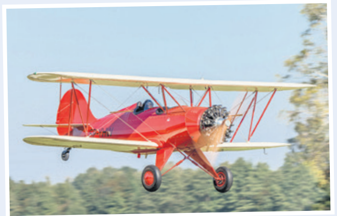
Hatz Classic - dwupłatowy samolot, którego skrzydła i śmigło są z drewna, kadłub z rur stalowych, konstrukcja pokryta płótnem
