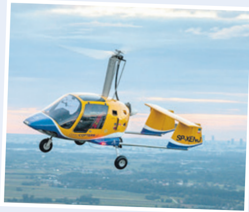
Wiatrakowce latają dzięki wirnikowi na konstrukcji nad pilotem, prędkość otrzymują ze śmigła napędzanego przez silnik
