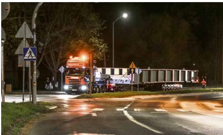
Przewożony element mostu miał długość około 40 m i szerokość 8 m
