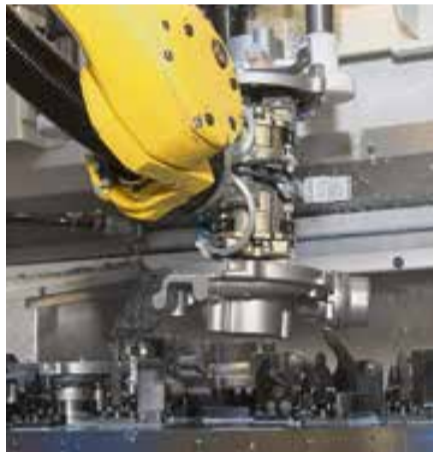
Obróbka aluminiowych odlewów do turbosprężarek odbywa się głównie przy pomocy robotów Fot. Materiały Spinko
