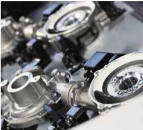
Obróbka aluminiowych odlewów do turbosprężarek odbywa się głównie przy pomocy robotów Fot. Materiały Spinko
