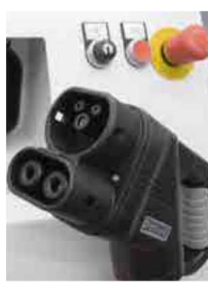
Tak wygląda wtyczka od urządzenia do ładowania elektrycznych autobusów
