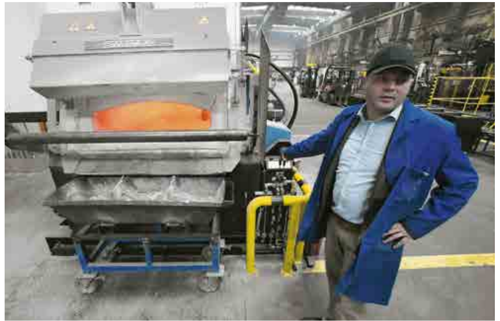
Marek Tarka, dyrektor ds. produkcji Lumel Alucast pokazuje piec hutniczy. - Topimy w nim gąski aluminiowe. Wewnątrz panuje temperatura 700 stopni - objaśnia.
