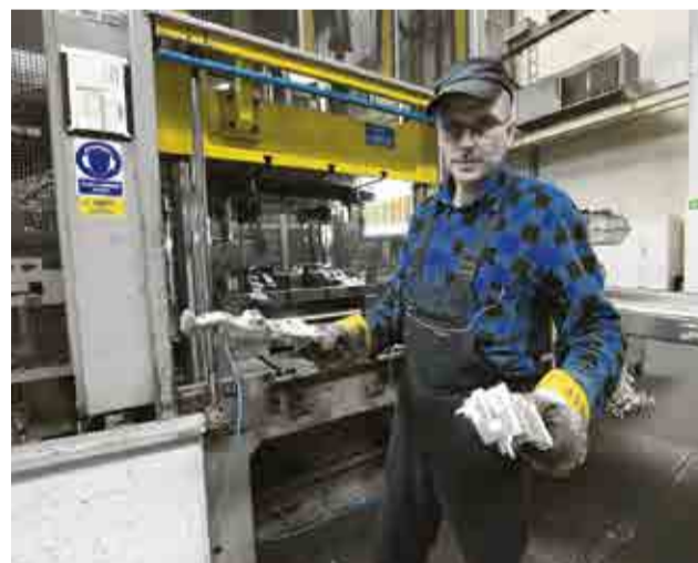
Jarosław Brajerek wyciąga z maszyny gotowe odlewy aluminiowe
