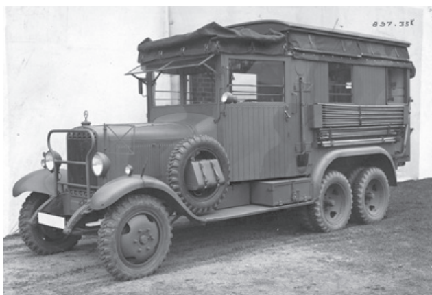
Różne wersje ciężarówki mercedes-benz G3a. Po lewej i w środku wersja z zabudowanym nadwoziem, służył jako wóz pomiarowy artylerii. Po prawej, wersja z brezentowym dachem – fotografia na tle willi Beuchelta – przystosowana do celów transportowych (na drogach mógł przewozić 1.500 kg ładunku lub 15 osób, w terenie – 1.000 kg ładunku lub 10 osób).
