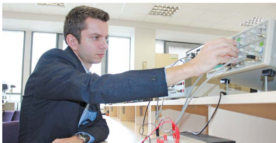
– Studenci uczą się mierzenia częstotliwości za pomocą oscyloskopu elektronicznego, do tego potrzebują wzorcowego generatora – to dla nas taki elementarz, tłumaczy Łukasz Macioszek, asystent w Instytucie Metrologii Elektrycznej.
